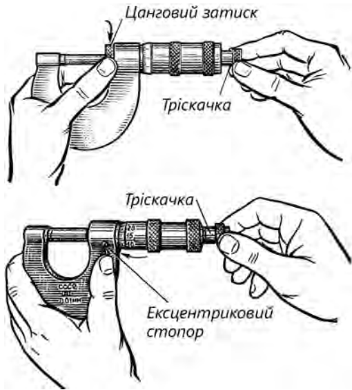
Рис. 2.69. Закріплення мікрогвинта стопором
