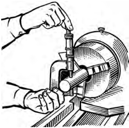
Рис. 2.79. Вимірювання деталі, закріпленої в патроні верстата
